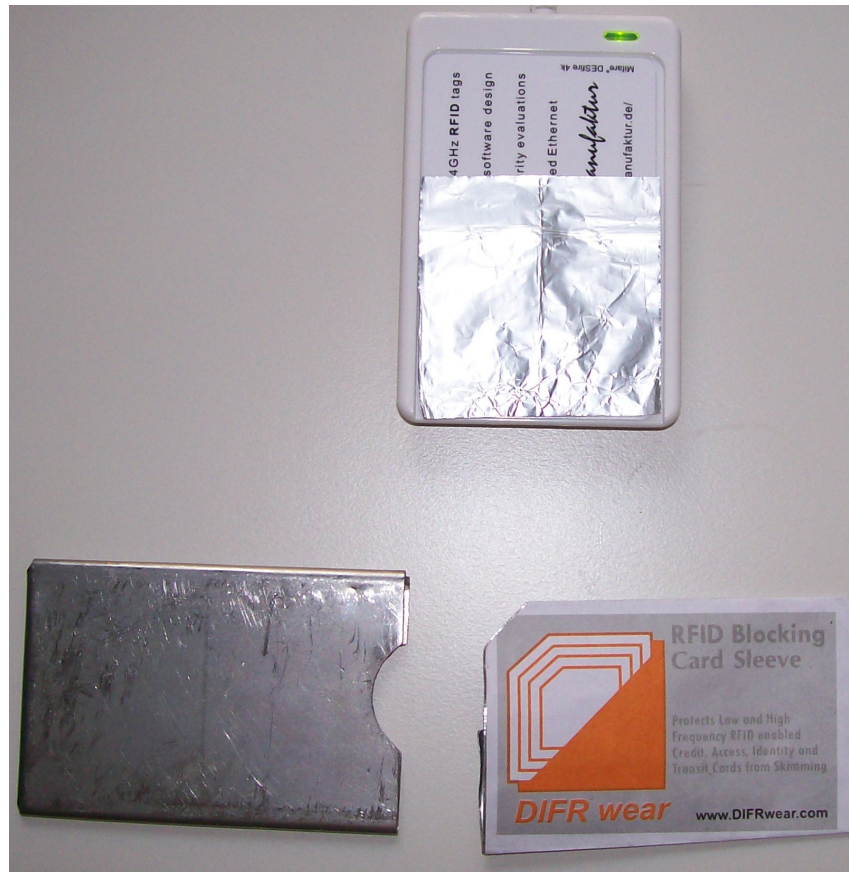
Abbildung 2.2: Verstärken bzw. Abschirmen einer PICC
